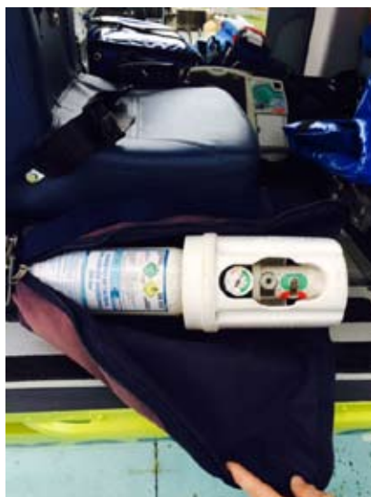
Oxígeno medicinal. Dos balas detrás del asiento del comandante, lado de la derecha de la aeronave, y otra en el lateral del lado izquierdo, portátil
