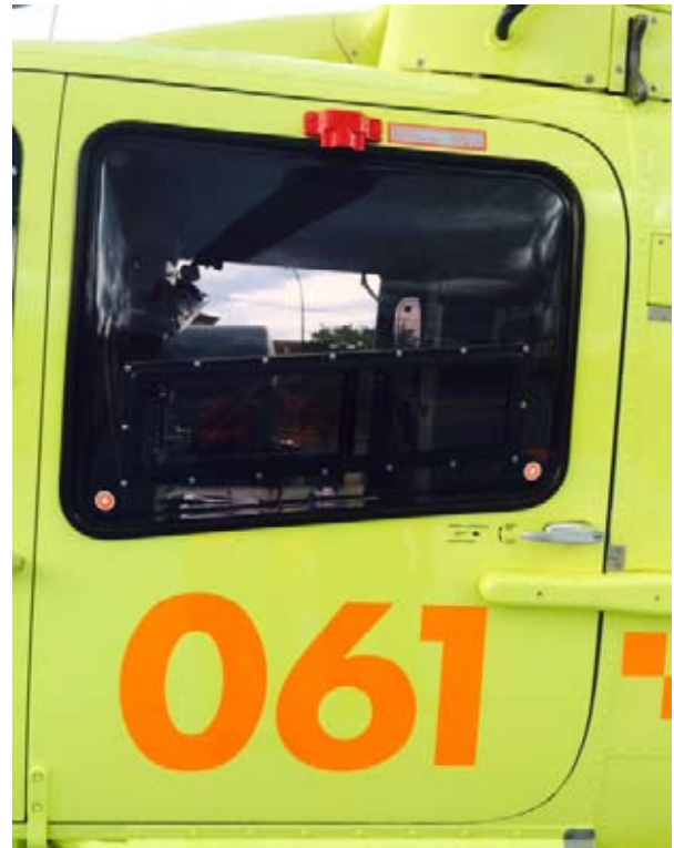
Salida de emergencia. Tirar de la maneta roja como se indica y empujar en los puntos rojos
