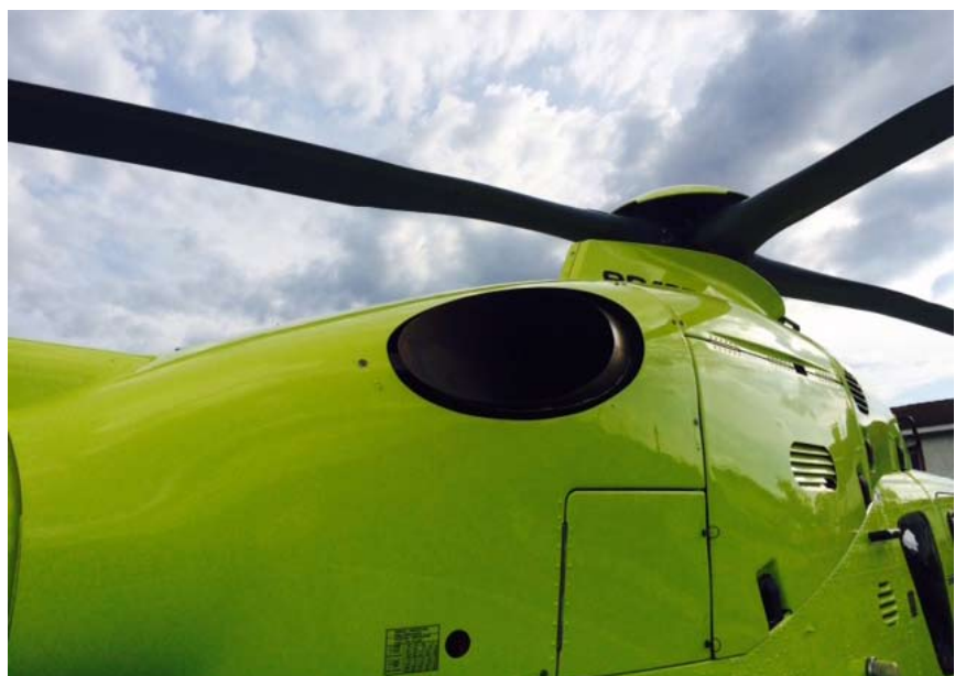
Tobera del EC-135 con motores encendidos foco de fuego
